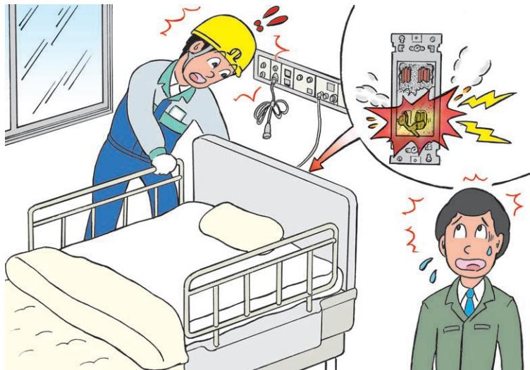
電源プラグが損傷し、そのまま放置したことにより、介護時等にベッドが動いた瞬間だけ接触して金属片同士が当たり(=ショートして)ブレーカーが動作したことが推測されました。
