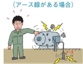
・電気機器や配線から漏電した場合、漏電遮断器を取り付けていれば、瞬時に漏電を感知して電気を自動的に切ることができます。しかし、漏電遮断器だけ取り付けられていてもアース線がなければ、人が触れた瞬間、人体から大地へ漏電電流が流れ、漏電遮断器が働くまでのわずかな時間、感電してしまいます。アース線と漏電遮断器はセットで取り付けましょう。
