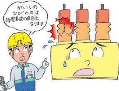
目視により碍子・碍管のひび割れ等の損傷がないかを確認します。
